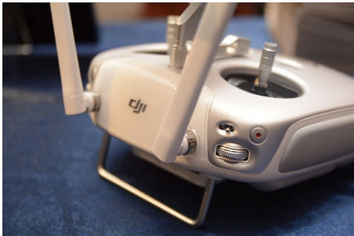
▲ 遙控器左側設有錄影按鍵、控制模式切換按鍵及雲台俯仰控制撥輪。
