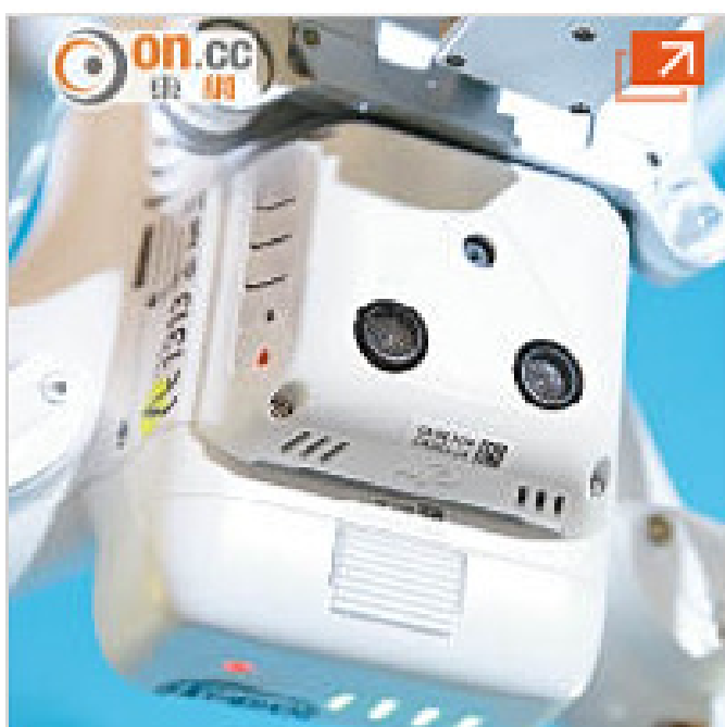
加入視覺定位系統，可感應地面及高度，平飛懸浮更穩定。
